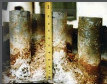
Tubos de cañón de calentador de agua tipo tanque tradicional con casi 6" de formación de sarro
